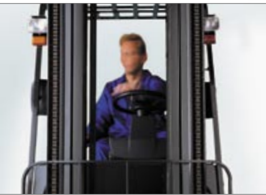
Die 2W-Freisichtmasten mit aussenliegenden Hubketten bieten hervorragende Sichtbedingungen
